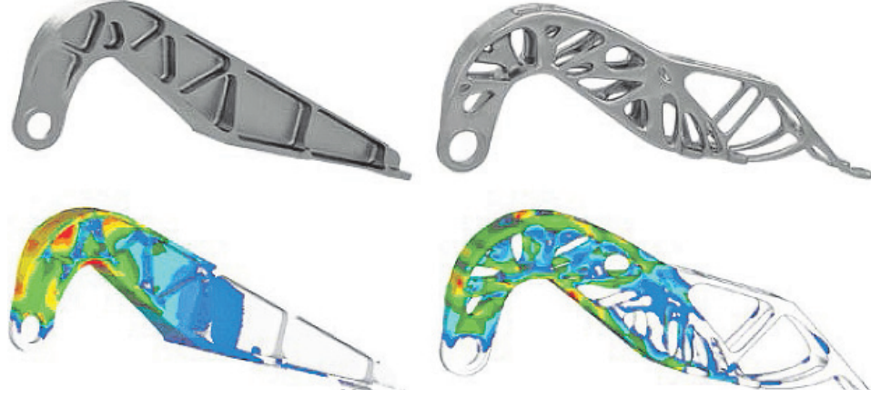
Бионический дизайн кронштейна каркаса самолета, изготовленный методом аддитивных технологий.
